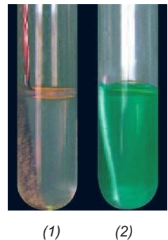
Hình 2.7. 1 - Đồng phản ứng với dd \text{AgNO}_3 2 - Bạc không phản ứng với dd \text{CuSO}_4
