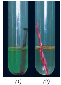
Hình 2.6 1 - Đinh sắt tác dụng với dd \text{CuSO}_4 2 - Dây đồng không tác dụng với dd \text{FeSO}_4
