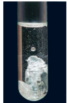
Hình 1.9. Nhôm tác dụng với dung dịch axit
