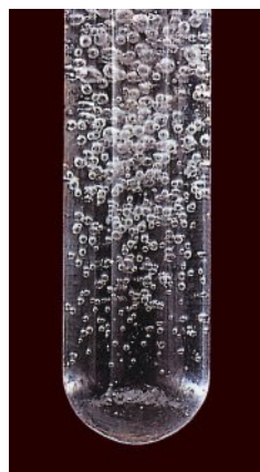
Hình 3.14. dd NaHCO 3 tác dụng với dd HCl
