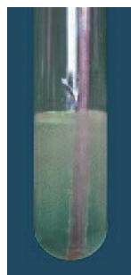
Hình 2.11. Nhôm phản ứng với dung dịch HCl
