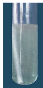
Hình 2.13. Nhôm phản ứng với dung dịch NaOH
