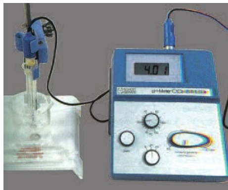
Hình 1.19. Thiết bị đo pH (pH kế)
