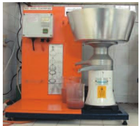
Hình 46.4. Máy li tâm chế biến sữa trong phòng thí nghiệm
