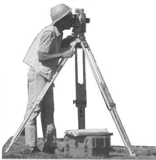
Hình 2.20. Giác kế dùng để ngắm và đo đạc.
