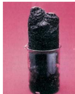
Hình 6.14. \text{H}_2\text{SO}_4 đặc tác dụng với đường
