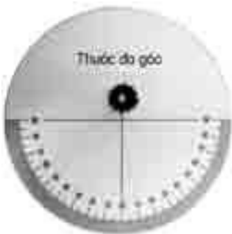
Hình 25.1 Thước đo góc gắn bên mặt phẳng nghiêng
