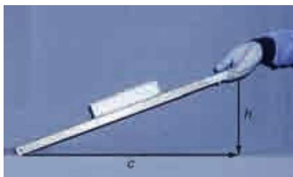
Hình 25.3 Nghiêng tấm ván để đo ma sát
