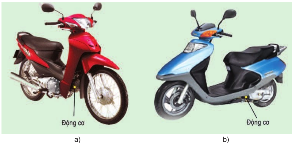
Hình 34.2. Bố trí động cơ trên xe máy
