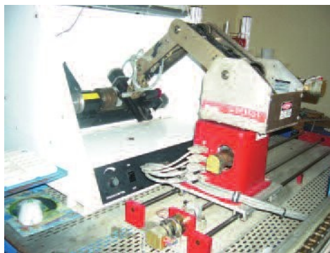
Hình 19.2. Ứng dụng rôbốt trong tháo lắp phôi trên máy công cụ
