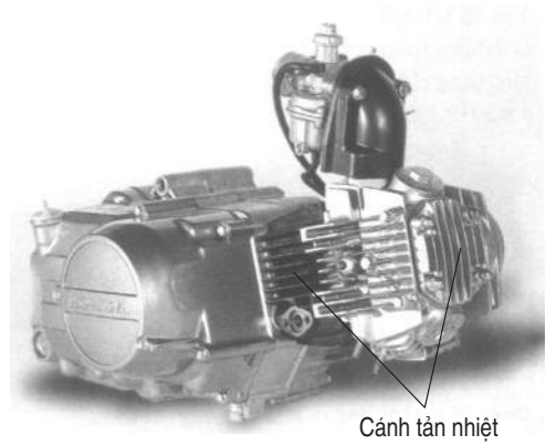
Hình 26.2. Động cơ làm mát bằng không khí
