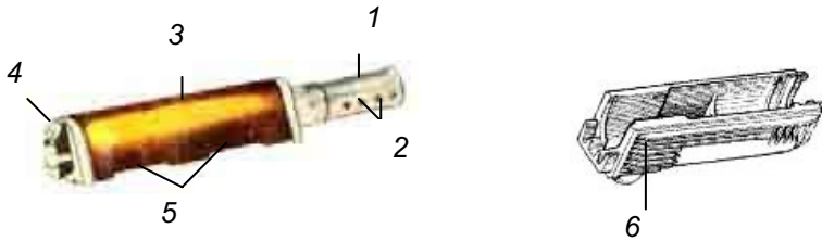
Hình 4-12. Cấu tạo của ống dẫn thoi và ốp lót tay
