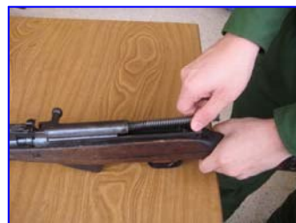
Hình 4-49. Tháo nắp hộp khoá nòng a, b) Tháo nắp hộp khoá nòng ; c) Tháo bộ phận đẩy về.
