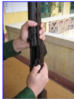
Hình 4-47. Mở hộp tiếp đạn và kiểm tra súng
