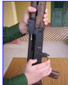
Hình 4-21. Tháo hộp tiếp đạn và kiểm tra súng
