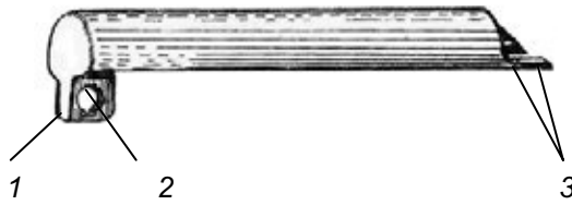
Hình 4-35. Nắp hộp khoá nòng 1. Mấu d ới ; 2. Lỗ lắp then hãm ; 3. Mấu lắp nắp hộp khoá nòng.
