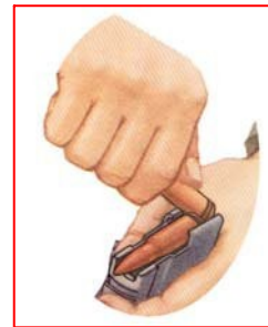
Hình 4-20. Tháo đạn khỏi hộp tiếp đạn.
