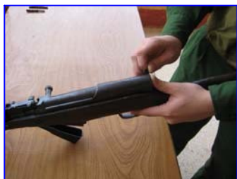
Hình 4-49. Tháo nắp hộp khoá nòng a, b) Tháo nắp hộp khoá nòng ; c) Tháo bộ phận đẩy về.
