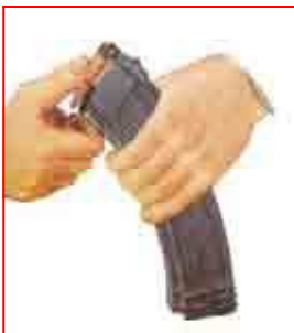
Hình 4-19. Lắp đạn vào hộp tiếp đạn.
