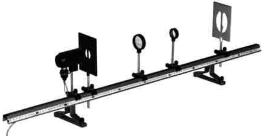
Hình 56.4 Xác định tiêu cự của thấu kính phân kì.
