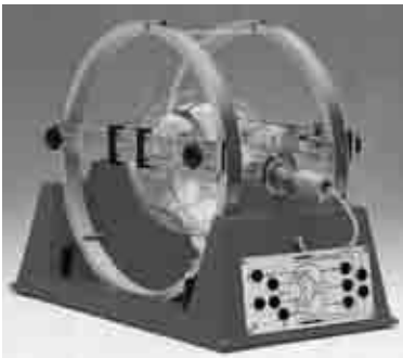
Hình 32.1 Thí nghiệm về chuyển động của êlectron trong từ trường.
